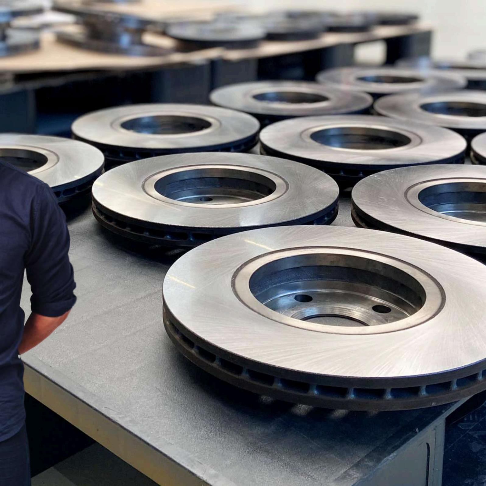
Beschichtete Bremscheiben entwickeln sich zur Benchmark, um die Reduzierung von Feinstaub-Emissionen des Bremssystems aller Kraftfahrzeuge und den erforderlichen Korrosionsschutz für die Bremsen von Elektrofahrzeugen zu erreichen.
