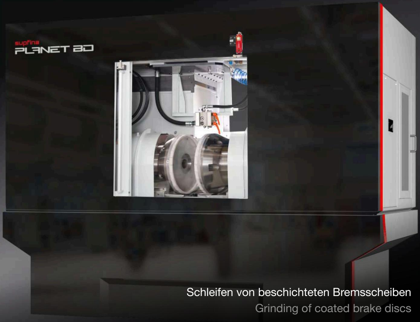
Schleifen von beschichteten Bremsscheiben
